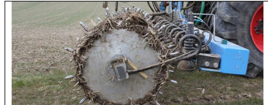
Abb. 7: Ausbringung von flüssigem Stickstoff-Dünger mittels Sternradtechnik zu Winterweizen im Frühjahr Foto: Thomas Würfel/LTZ
