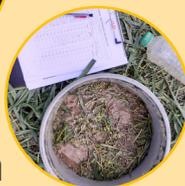
Mesure de la vitesse d'infiltration d'un volume d'eau connu
