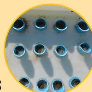
Mesure de la désagrégation dans l'eau de petits agrégats (8mm)
