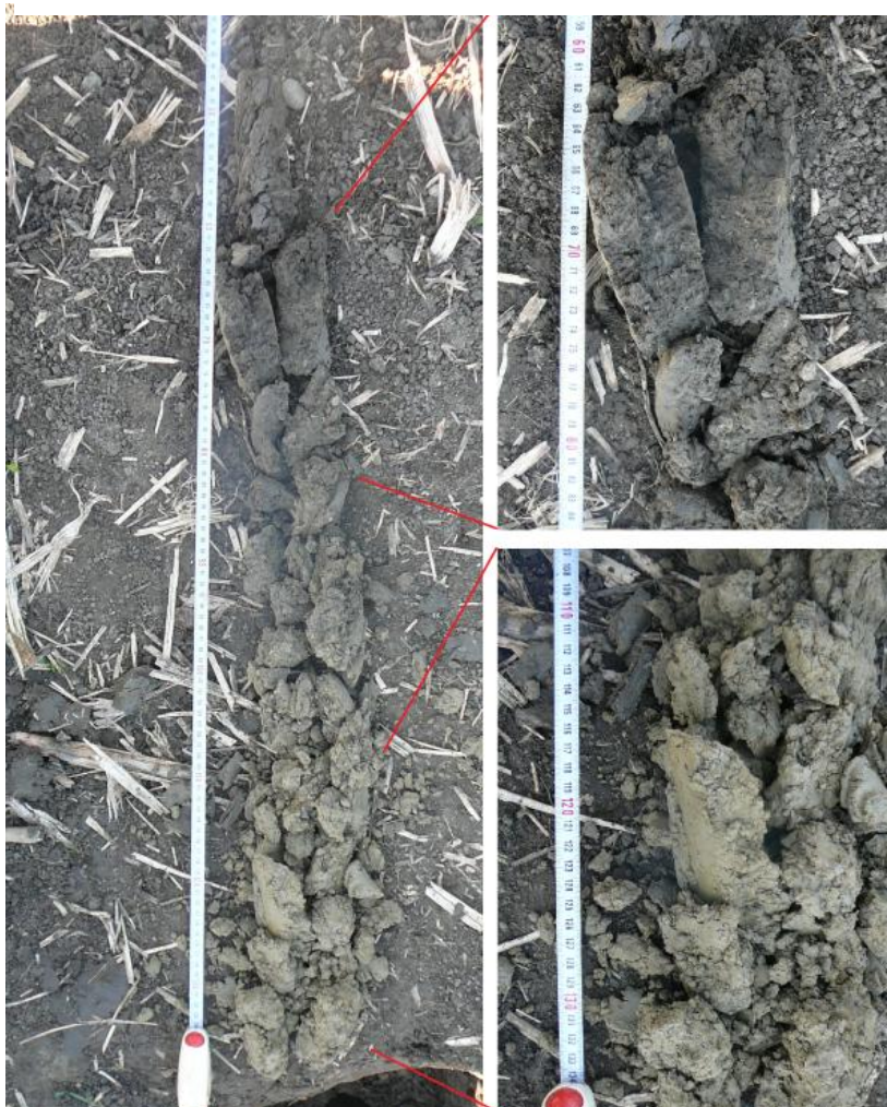
Figure 5 : photo du profil à la tarière
